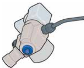
Ręczny zawór odcinający na zaworze głównym zbiornika
