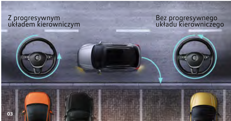
03 Progresywny układ kierowniczy T-Roca Premium ułatwia zachowanie kontroli nad samochodem podczas sportowej jazdy i zapewnia dodatkowy komfort w codziennym użytkowaniu. Progresywny układ kierowniczy zmniejsza siły potrzebne do skrętu przy parkowaniu, a bardziej bezpośrednie przełożenie poprawia dynamikę na krętych drogach.
