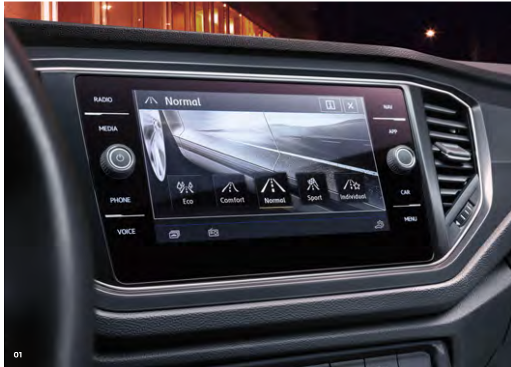
01 Opcjonalna funkcja wyboru profilu jazdy pozwoli Ci wybrać profil, którego w danej chwili potrzebujesz: Normal, Eco, Sport, Comfort lub Individual. Sposób pracy silnika, przekładni i niektórych systemów wspomagających zostanie dostosowany do panujących warunków. W profilu Individual możesz dostosować ustawienia poszczególnych parametrów do swoich preferencji.
