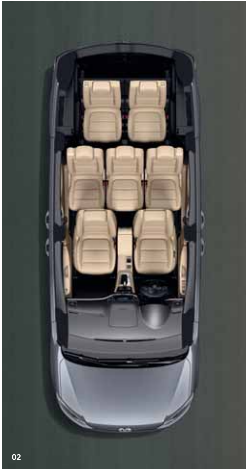
02 W wersji 7-osobowej Sharana także osoby siedzące w trzecim rzędzie mogą wygodnie wsiadać i wysiadać – siedzenia drugiego rzędu składają i przesuwają się do przodu dzięki funkcji Easy Entry. O
