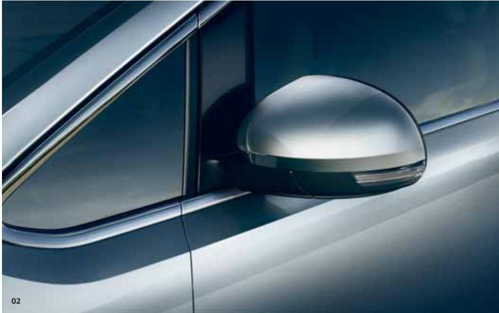
02 Kierunkowskazy LED są elegancko wkomponowane w obudowy lusterek zewnętrznych. Lusterka są podgrzewane, elektrycznie regulowane i pokryte lakierem w kolorze nadwozia. S
