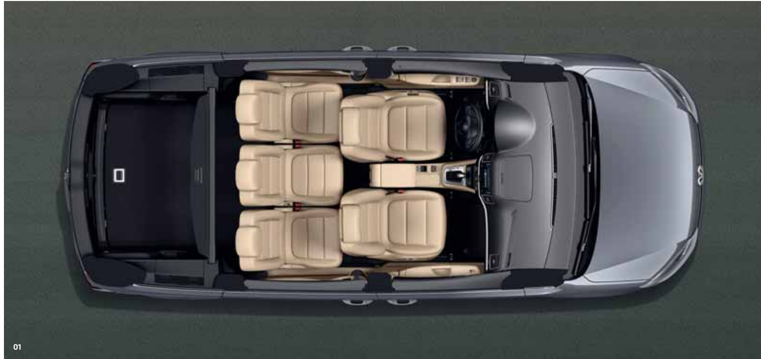
01 Bagażnik Sharana w wersji 5-osobowej ma pojemność aż 955 litrów. Możesz oddzielnie przesuwając pojedyncze tylne siedzenia lub złożyć ich oparcie, aby powiększyć przestrzeń na bagaż do nawet 2430 litrów. Możesz także złożyć oparcie fotela obok kierowcy 1) . S
