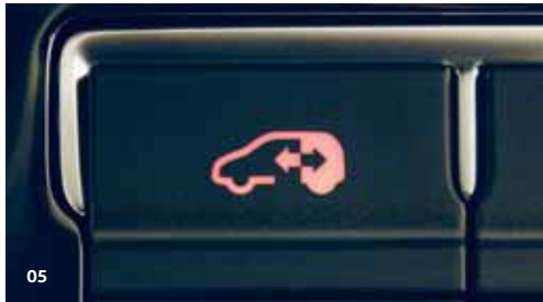
05 Elektrycznie rozsuwane tylne drzwi ułatwiają wsiadanie i wysiadanie, na przykład na ciasnych parkingach. Także wkładanie bagażu jest wygodniejsze. Aby otworzyć i zamknąć drzwi, wystarczy wcisnąć odpowiedni przycisk. O
