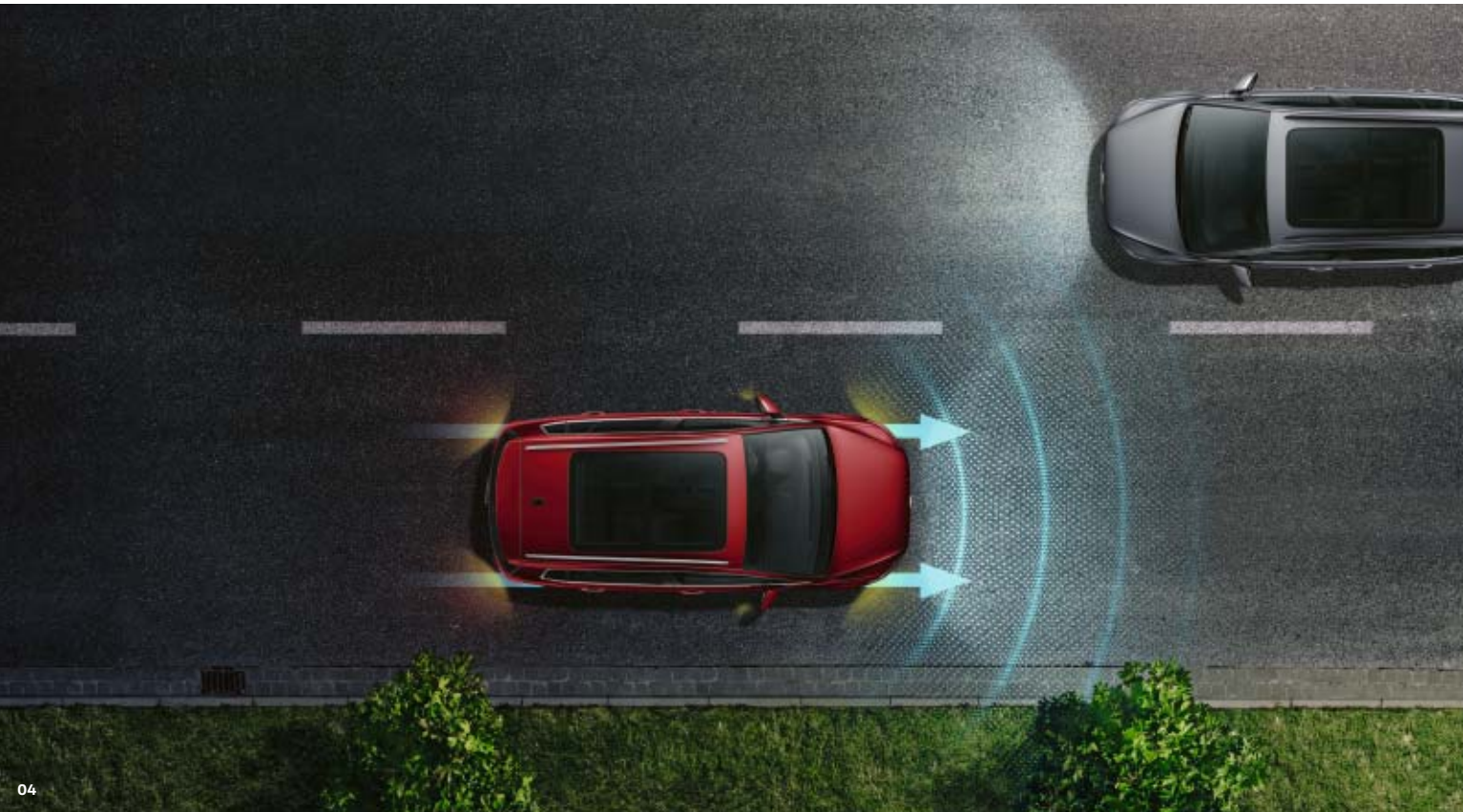
04 Z Emergency Assist 3) będziesz przygotowany nawet na krytyczne sytuacje, gdyż system jest w stanie przejąć na siebie częściową kontrolę nad samochodem w przypadku niezdolności kierowcy do prowadzenia pojazdu, na przykład z przyczyn zdrowotnych 1) . System zaczyna działać, gdy zarejestruje brak reakcji kierowcy. Jeżeli mimo ostrzeżeń kierujący pojazdem nadal pozostanie bierny, Emergency Assist spróbuje przywrócić jego aktywność oraz ostrzec pasażerów i innych uczestników ruchu 1) . Jeśli kierowca nie przejmie kontroli nad samochodem, system może utrzymać samochód na pasie ruchu i przyhamować aż do zatrzymania 1) . O
