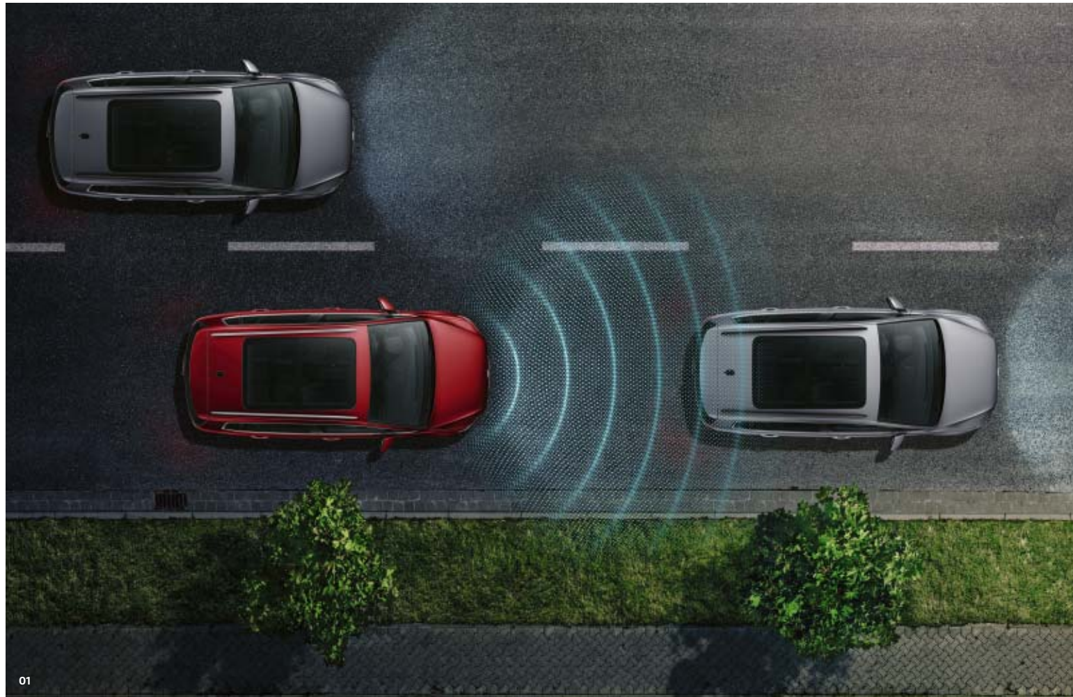
01 Komfort nawet w korku. Asystent jazdy w korkach umożliwia wygodne podążanie za jadącym z przodu pojazdem i może pomóc uniknąć typowych kolizji zdarzających się w korkach 1) . System może utrzymywać samochód na wybranym pasie ruchu i samoczynnie przyspieszać oraz hamować 1) . O
