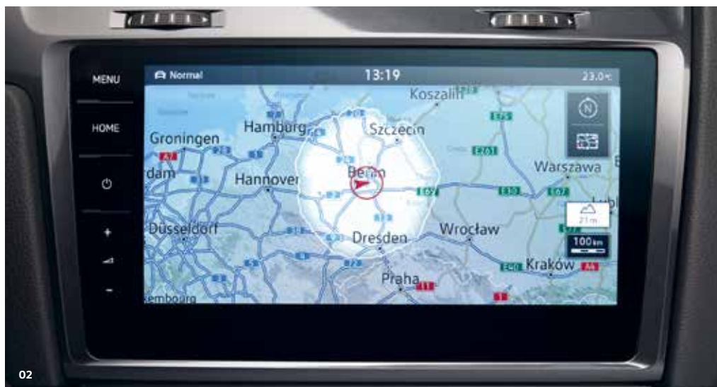
02 Na monitorze zasięgu w formie graficznej prezentowany jest zasięg przy wybranym aktualnie profilu jazdy. S
