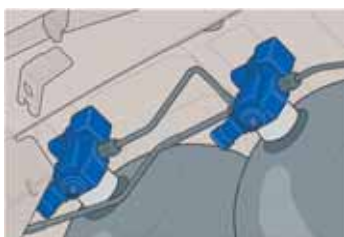
Elektromagnetyczne zawory odcinające na zbiornikach gazu
